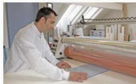
Нанесение двухстороннего скотча GM-107 СС на акриловое стекло
